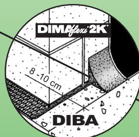
Le raccordement étanche entre **DIBA** en horizontal et **DIMAflexi 2K** en vertical.
